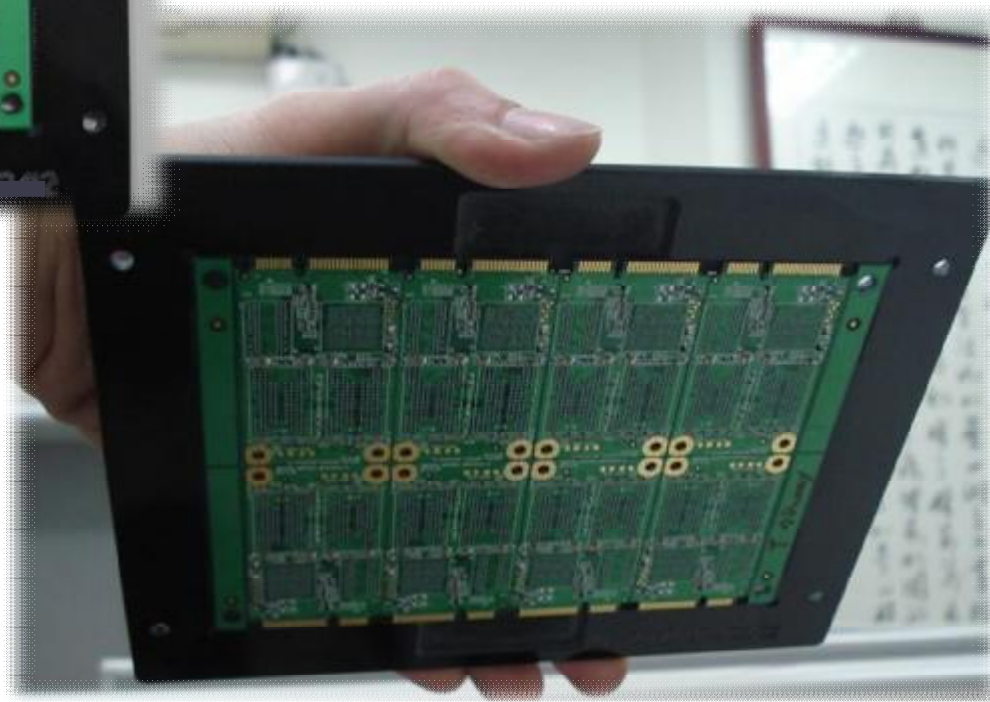
圖7、將治具翻轉後PCB不掉落，證明膠帶黏性良好
